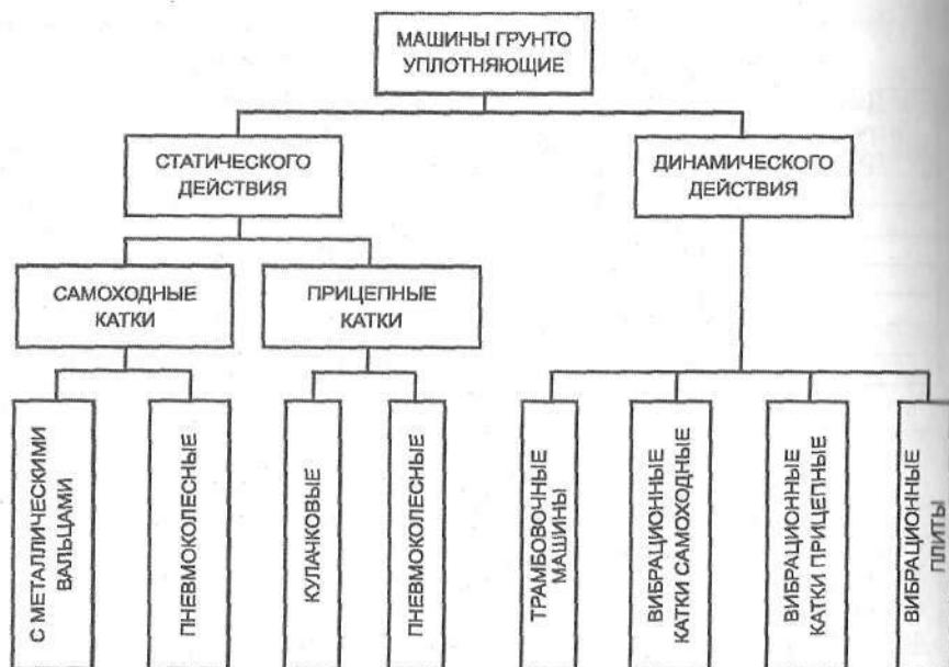
Рис. 2.10.1. Классификация выпускаемых грунтоуплотняющих машин.
